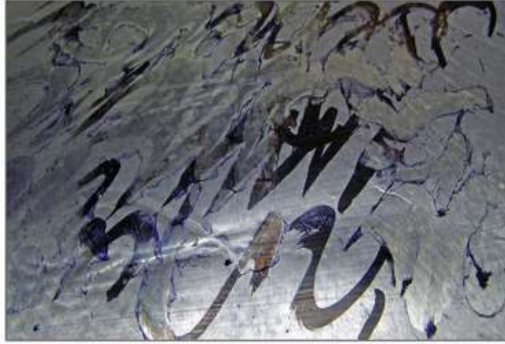
Resim 9. Kalıbın silme aşamasında hasar görmesi
