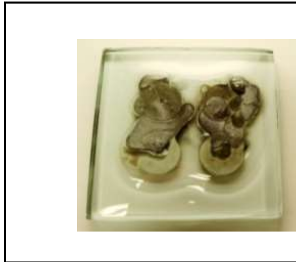
Fotoğraf 3.2.1. Cam-kurşun füzyonu Şişecam Düzcem (6mm+6mm)
