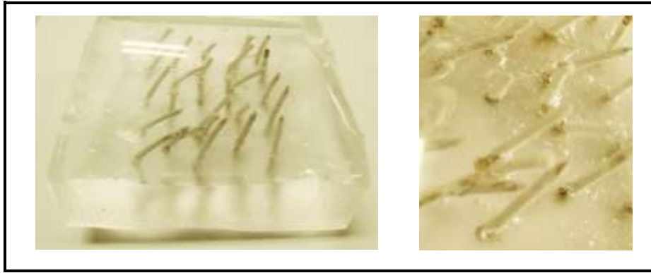
Fotoğraf 3.5.2. Açık kalıp tekniğinde cam ve pirinç pişirim sonucu
