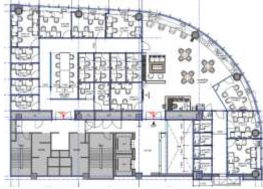
Şekil 34. Mitsui Fudosan Co., Ltd.: İletişim, Toplantı ve Konferans Salonlarının Bulunduğu Paylaşımlı Ofis Planı (mitsuifudosan.co.jp)
