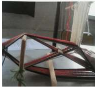
Resim 17: Kolan dokuma (çift katlı gücülü dar dokuma) işlemleri için çözgü iplikleri ve ağızlık açma işlemi Marmara Üniversitesi GSF Atelyesi, (Tüm: 2010)
