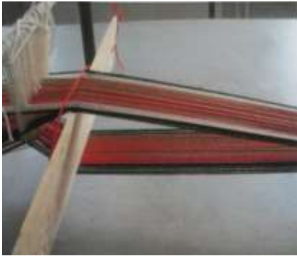
Resim 17: Kolan dokuma (çift katlı gücülü dar dokuma) işlemleri için çözgü iplikleri ve ağızlık açma işlemi Marmara Üniversitesi GSF Atelyesi, (Tüm: 2010)
